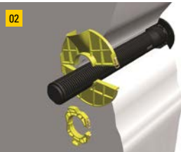
Die Verfüllvorrichtung und die Dichtscheibe wird nun auf dem Rundgewindemantel an der anderen Mauerseite angelegt und mit dem Klemmverschluss geschlossen. Die Anstellmutter muss ebenfalls angelegt und geschlossen werden.
