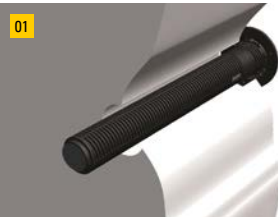
Die ARO-Platte im vorderen Bereich aufdrehen und gewünschten Wandabstand einstellen. Beim Einbau wird die WHP in den gebohrten oder gestemten Mauerdurchbruch bis zum Anschlag der ARO-Platte vom Keller her eingeführt.
