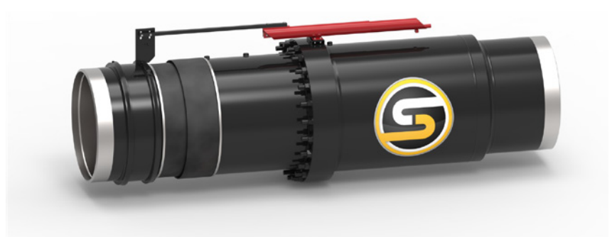
Bild 1: Linearkompensatoren werden weltweit in Pipelines eingesetzt, die sich in Senkungs- bzw. Erdbebengebieten befinden oder erhöhten thermischen Einflüssen unterliegen, um die auftretenden Spannungen zu minimieren und einen Längenausgleich zu schaffen
