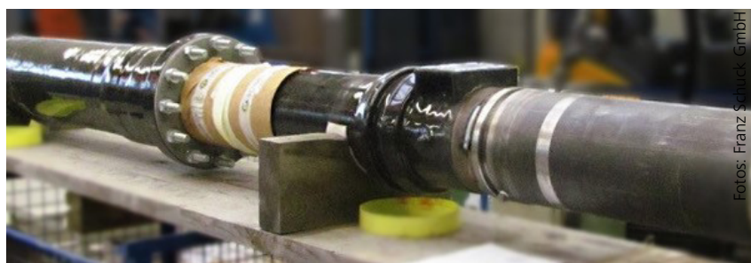
Bild 3: Reibkraftmessung an einem DN 200 / PN 70 Linearkompensator
