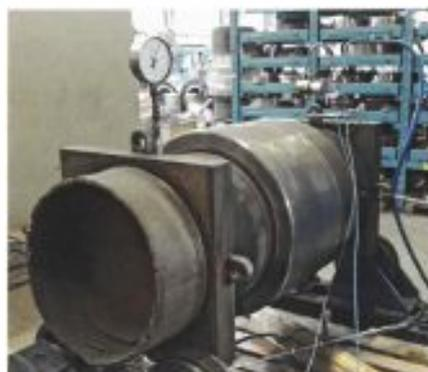
Baumuster mit bereits abgetrennten Rohren beim Innendruckschwellversuch
