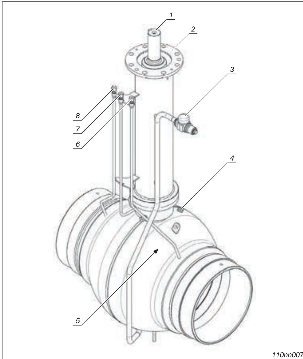
Fig. 3-2 Systemübersicht Kugelhahn Typ G / SMK, Unterflur
