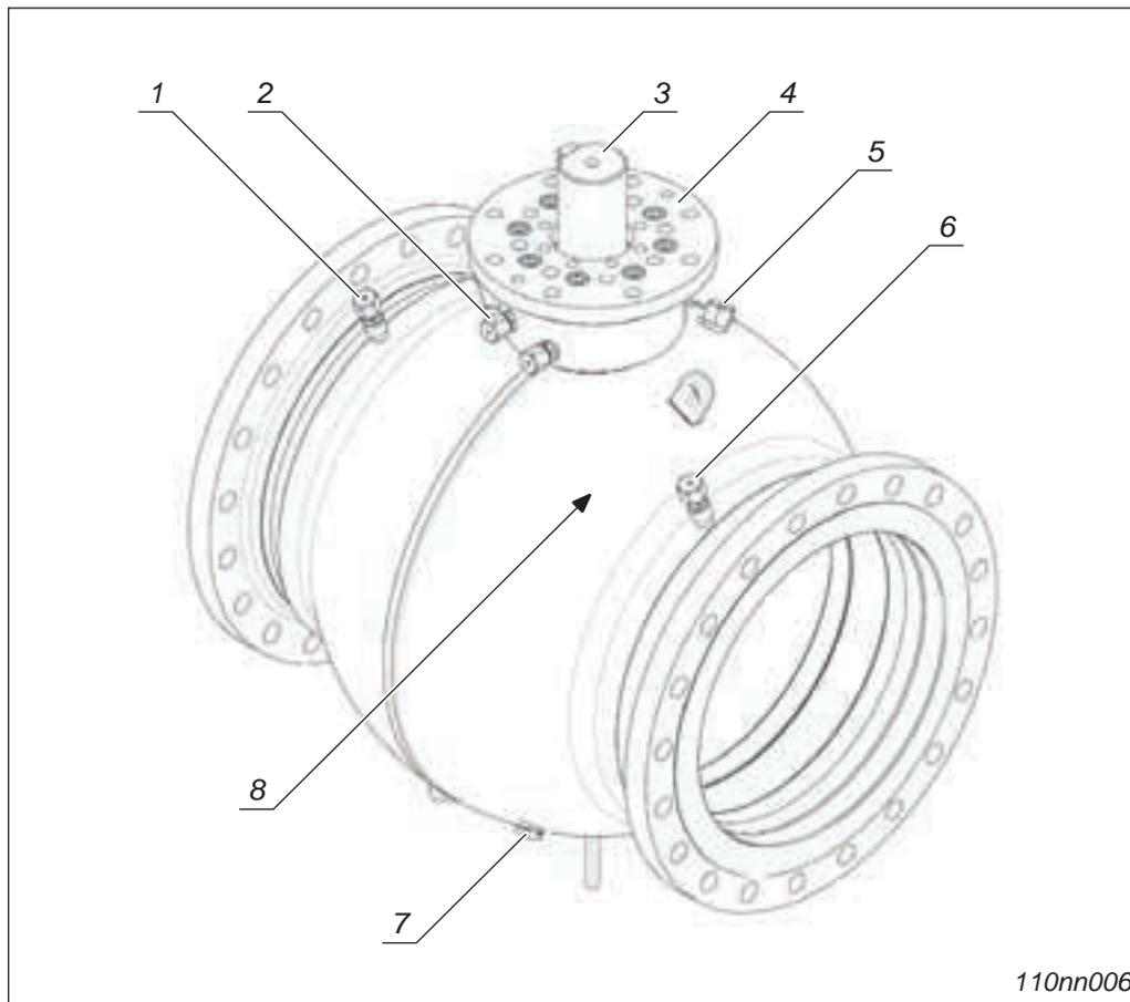
Fig. 3-1 Systemübersicht Kugelhahn Typ G / SMK, Überflur
