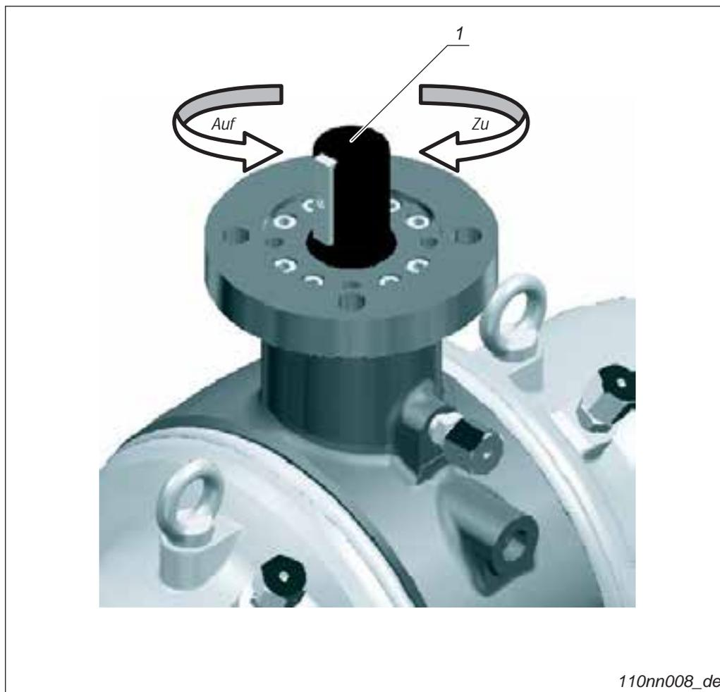
Fig. 5-1 Armatur öffnen/schließen
